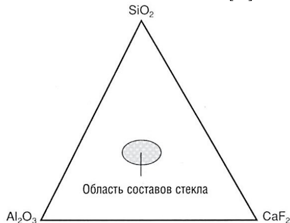
Рис. 1. Область составов стекла, применяемого для получения СИЦ [20]
