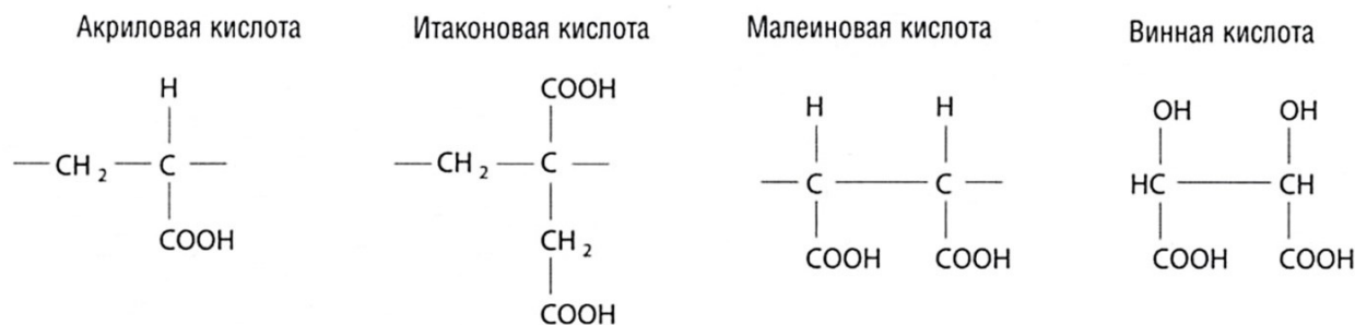
Рис. 3. Структурные формулы кислот, используемых в жидкости затвердения СИЦ [20]
